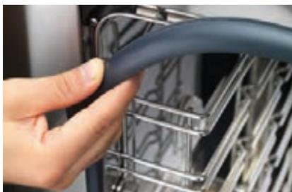
Professionelle, abnehmbare Dichtung für eine einfache Demontage zur Reinigung oder zum Austausch.
